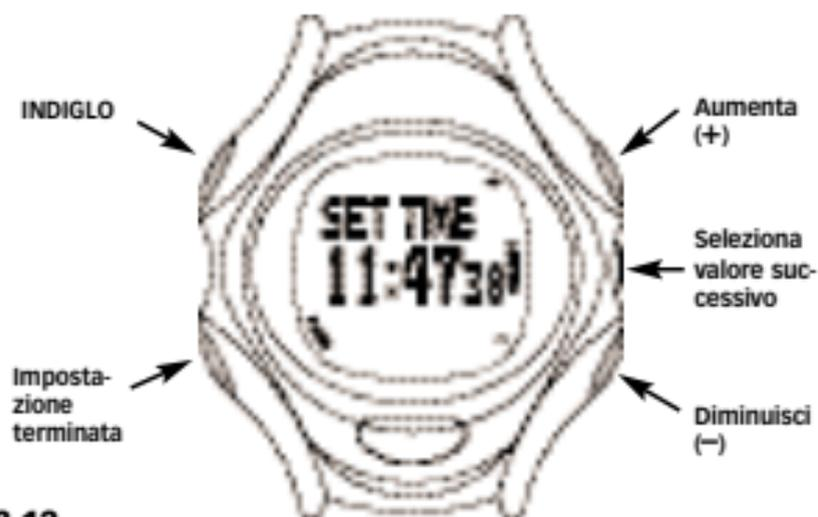
Ecco un secondo esempio delle funzioni dei pulsanti nella modalità Dati sul giro. Qui i pulsanti cambiano funzione per permettere all'utente di passare in rassegna i dati sul giro memorizzati. Ancora una volta, la nuova funzione di ciascun pulsante viene indicata sul display dell'orologio.
