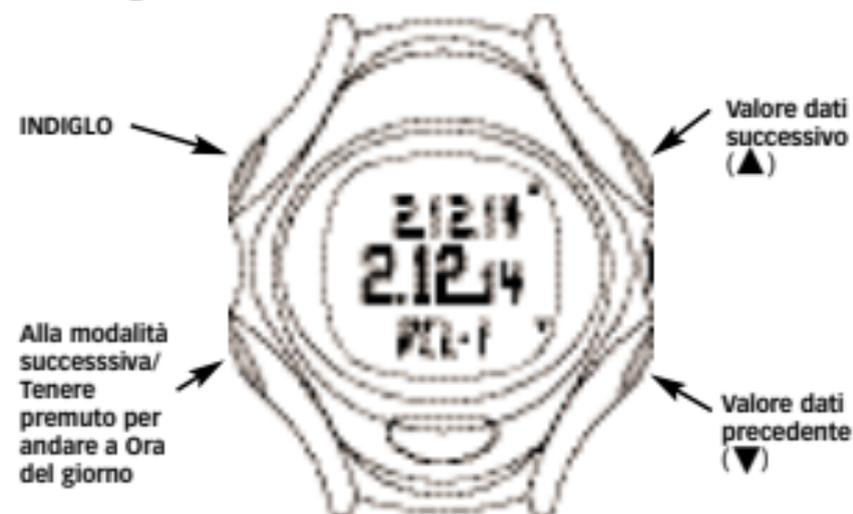
Non è necessario ricordare l'esatta funzione dei pulsanti in ciascuna modalità; basta ricordare quanto segue. **Quando la funzione di un pulsante cambia rispetto al suo normale funzionamento, l'orologio ricorda all'utente la nuova funzionalità del pulsante visualizzandola.**
