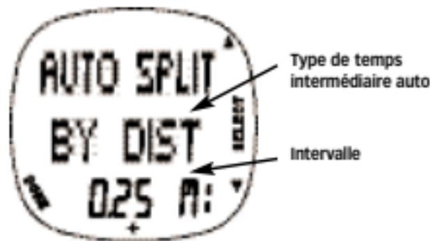
La configuration de la fonction de marquage automatique des temps intermédiaires se fait dans l'ordre suivant :
