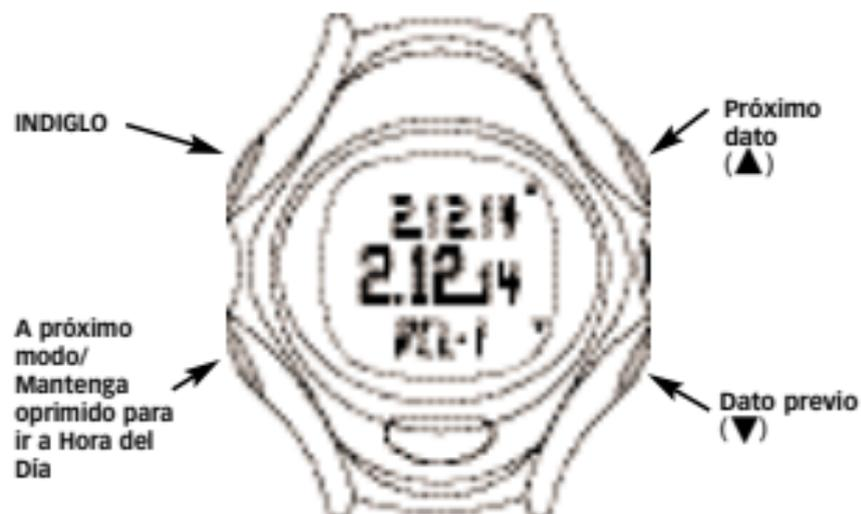
No es necesario que recuerde la función exacta de los botones en cada modo; simplemente recuerde que cuando la función de un botón cambia, el reloj le recordará cuál es la nueva función, para lo cual le mostrará dicha nueva función.
