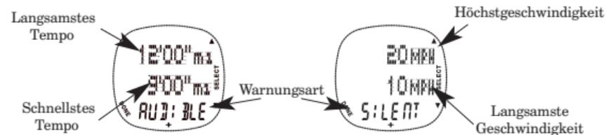
**HINWEIS:** Geschwindigkeits- und Tempogrenzwerte können separat eingestellt werden. Stellen Sie z. B. Tempogrenzwerte ein, um das Tempo Ihres Laufes zu kontrollieren und Geschwindigkeitsgrenzwerte speziell für Radfahren. Schalten Sie dann einfach zwischen den Einstellungen für jede Aktivität um.
