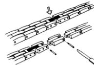
**Remontage :** Mettre les pièces du bracelet en place et introduire la vis du côté où elle a été extraite. La tourner dans le sens des aiguilles d'une montre jusqu'à ce qu'elle ne dépasse plus du bracelet.
