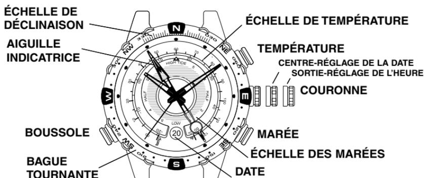
REMARQUE : La couronne de la montre est protégée pour l'expédition. Retirer le capot de protection et enfoncer la couronne pour mettre en marche. **La boussole doit être étalonnée avant utilisation pour garantir sa précision et éviter les erreurs d'orientation.** Se reporter à ÉTALONNAGE DE LA BOUSSOLE. Consulter [www.timex.com/expedition](http://www.timex.com/expedition) pour assistance.
