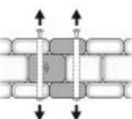
**Remontage :** Mettre les pièces du bracelet en place et introduire la goupille du côté où elle a été extraite. Tourner la vis de l'autre côté dans le sens des aiguilles d'une montre jusqu'à ce qu'elle ne dépasse plus du bracelet.
