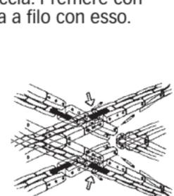
**Rimontaggio:** riunire le parti del bracciale ed inserire la vite all'estremità dell'apertura dalla quale era stata rimossa. Avvitare la vite girandola in senso orario finché non resta a filo con il bracciale.
