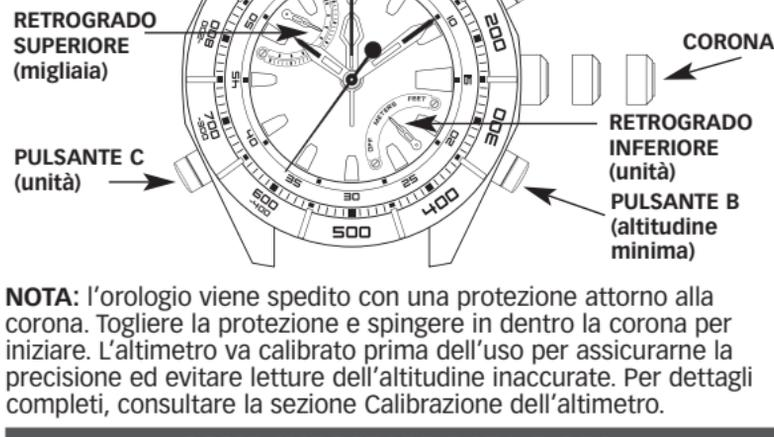
**NOTA:** l'orologio viene spedito con una protezione attorno alla corona. Togliere la protezione e spingere in dentro la corona per iniziare. L'altimetro va calibrato prima dell'uso per assicurarne la precisione ed evitare letture dell'altitudine inaccurate. Per dettagli completi, consultare la sezione Calibrazione dell'altimetro.
