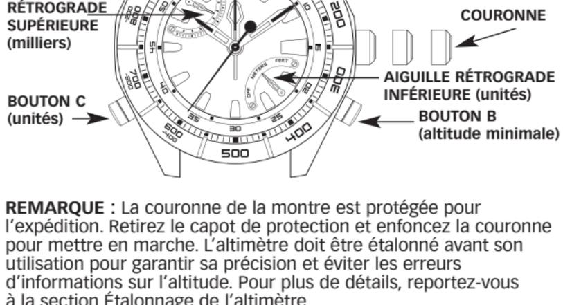
**REMARQUE :** La couronne de la montre est protégée pour l'expédition. Retirez le capot de protection et enfoncez la couronne pour mettre en marche. L'altimètre doit être étalonné avant son utilisation pour garantir sa précision et éviter les erreurs d'informations sur l'altitude. Pour plus de détails, reportez-vous à la section Étalonnage de l'altimètre.
