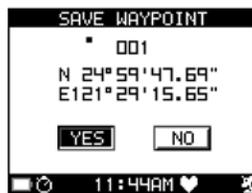
3. Pressione ▲ ou ▼ para selecionar YES; depois, pressione ↵ para gravar o ponto de referência e voltar à Waypoint List (lista dos pontos de referência). Selecione NO; depois, pressione ↵ para voltar à Lista dos Pontos de Referência sem gravar.
