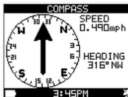
Uma seta aponta para a posição das 12 em ponto enquanto o anel da bússola gira ao redor, indicando a direção do seu percurso. A velocidade e a direção atuais (em direção e graus) estão indicadas à direita da bússola.
