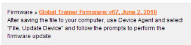
**OBSERVAÇÃO:** Ao fazer o download de um novo firmware no relógio Global Trainer™ se apagam as configurações, conforme mostradas na aba Settings (configurações) do Device Agent, a menos que você as grave.
